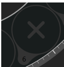
Figura 7.12 Designação de poço inativo
